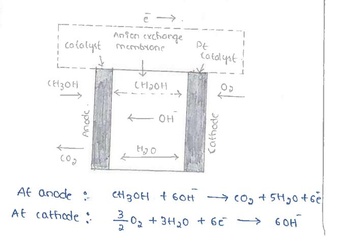
Net reaction:  $(H_3OH + \frac{3}{2}O_2) \rightarrow (O_2 + 2H_2O_2)$ Applications:
